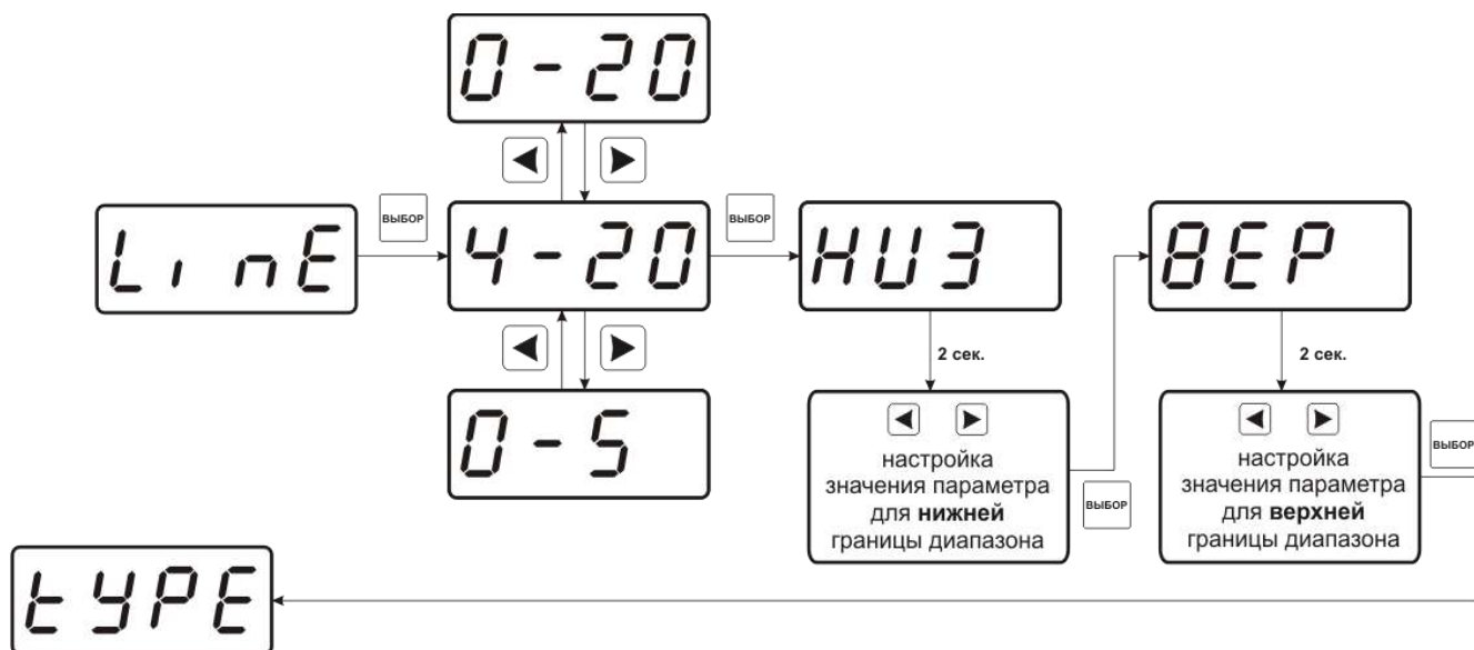
Рисунок 6.16 Схема настройки токового выхода.
